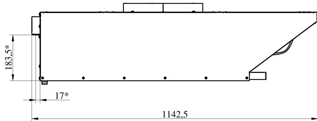
Зонт вытяжной встраиваемый ЗВВ-10-6/4М используется для очистки воздуха от аэрозолей жира, масла, водяного пара и устанавливается в системе вытяжной вентиляции на объектах общественного питания.
